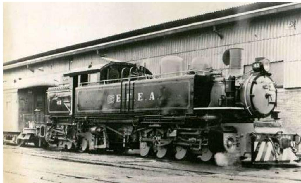
La Kitson 43 modernizada con tanques extendidos y el sistema auxiliar de cremallera removido.
